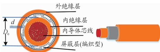
图 2 屏蔽线缆结构示意图
