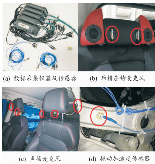
图 2 数据采集仪器及传感器布置示意图
